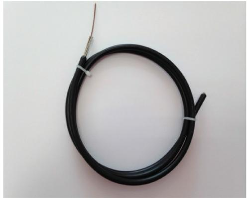
图 1 钢绞线封装分布式光纤传感器
