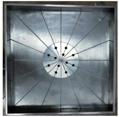
图 3 帚状旋转构造模拟仪
