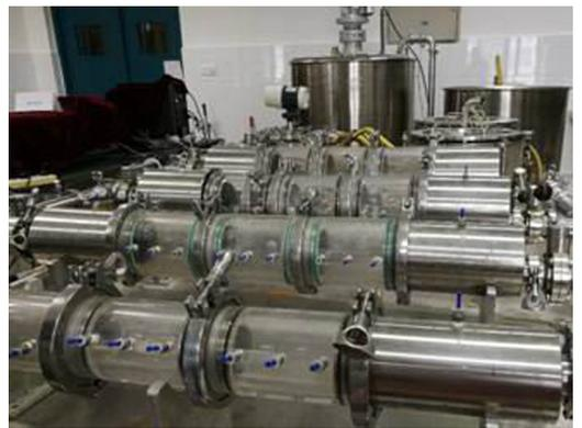
图2 砾石层特性评价微观驱替模拟试验装置
